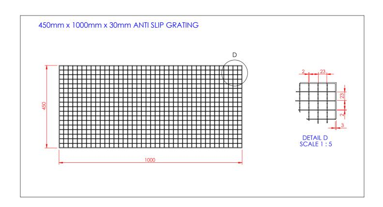
NOTE: THE GRATINGS ARE NOT SUITABLE FOR PALLET TRUCK TRAFFIC OR FORK LIFT TRAFFIC
